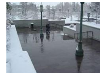
primer sistema grejanja koji deluje ispod površine šetališta
